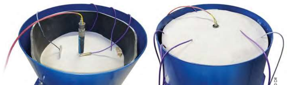
Chambre d'essai avec différents capteurs de mesure et sonde prototype.
