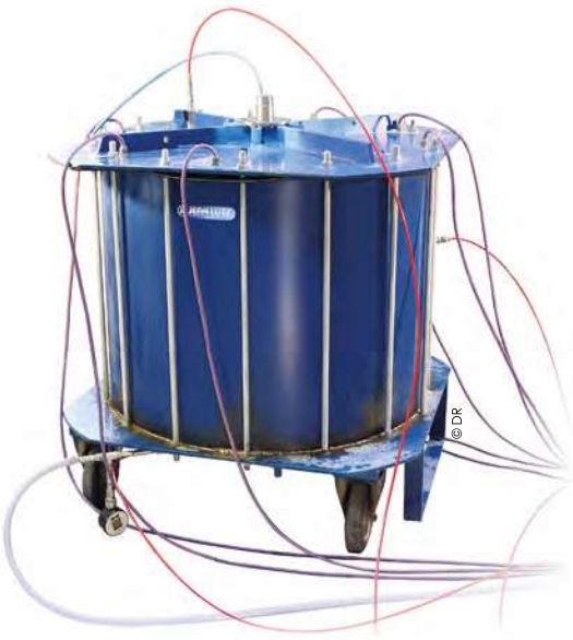
La chambre d'essai instrumentée en pression (4 bar).
